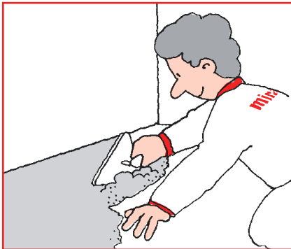
Segu valatakse põrandale
