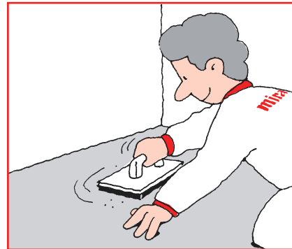
30-60 minuti möödudes hakkab segu kivinema ning pealispinda on võimalik silestada. Silutud kattedepinda saab kasutusele võtta ka katmata. Soovi korral võib põrandakatte maha panna 2-3 tunni möödudes.
