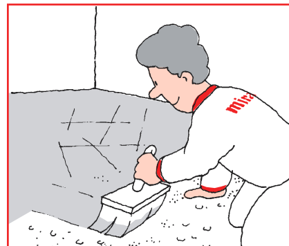
Täiteks segatakse 4730 cembond veega vahekorras 1:2 ning lisatakse tasandussegule, kuni saadakse paksenenud mass.
